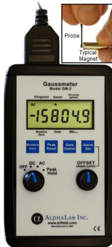
Предназначен для измерения постоянных и переменных магнитных полей.
