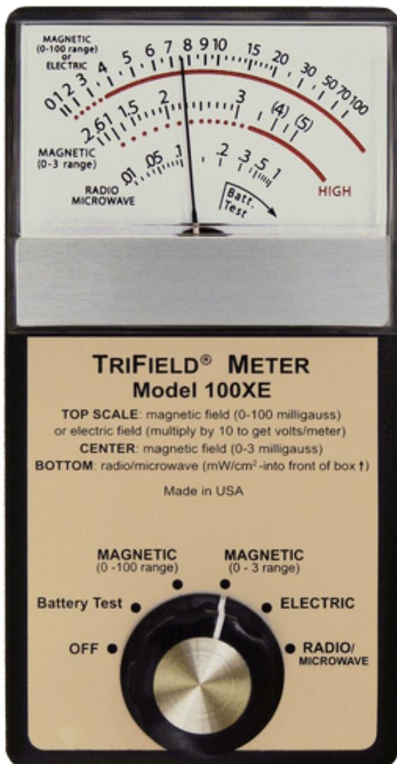
Данная аналоговая модель представляет собой 3-х векторный магнитометр АС с дополнительными функциями измерения электрических АС и радио/микроволновых полей.
