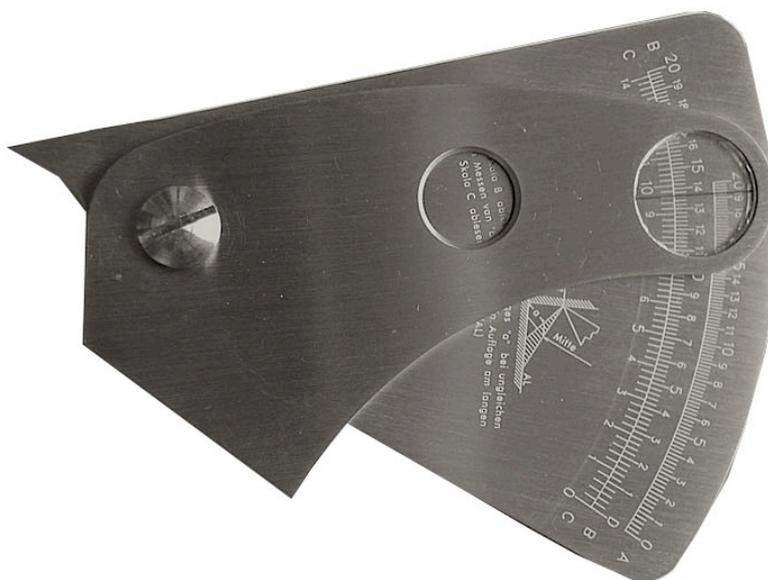
Предназначен для измерений углового шва: высоты шва, катета углового шва
