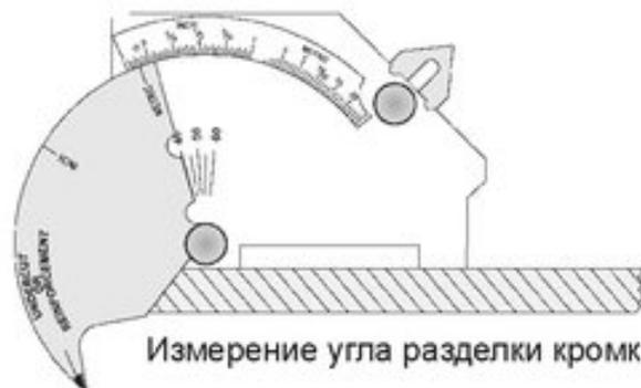
Измерение угла разделки кромки
